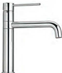
Dřezová stojánková baterie COX Otočné ramínko Výška celková: 265 mm Výška výtoku: 133 mm Vzdálenost od osy baterie do osy výtoku: 200 mm Kartuš: ø35 mm (PP 53CC956GM)
