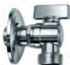
Kulový kohout rohový pračkový Jmenovitý pracovní tlak: PN 10 Rozsah pracovních teplot: -10°C až +90°C Materiál: mosaz MS 58 - pochromovaná
