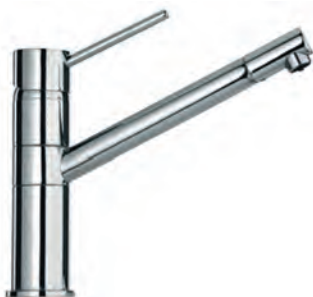
Dřezová stojánková baterie COX Otočné ramínko Výška celková: 200 mm Výška výtoku: 157 mm Vzdálenost od osy baterie do osy výtoku: 200 mm Kartuš: ø35 mm (PP 53CC956GM)
