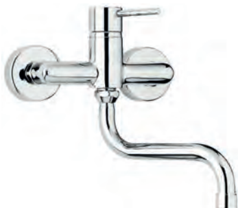
Dřezová nástěnná baterie COX Lze použít i jako umyvadlovou baterii Kartuš: ø35 mm (PP 53CC956GMD)
